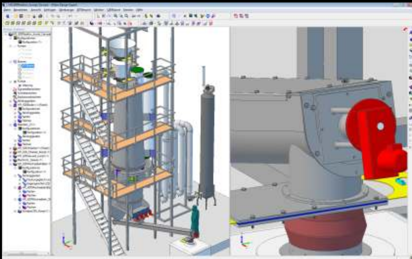
Hoch effizienter Holzkohlenreaktor © by Ing.Unternehmung Henzi
